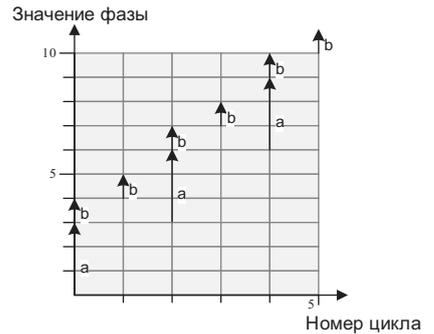
Рис. 4. Временная диаграмма для конвейера с функцией *mul*
