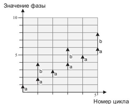
Рис. 5. Временная диаграмма конвейера со спусковой функцией *DIV*
