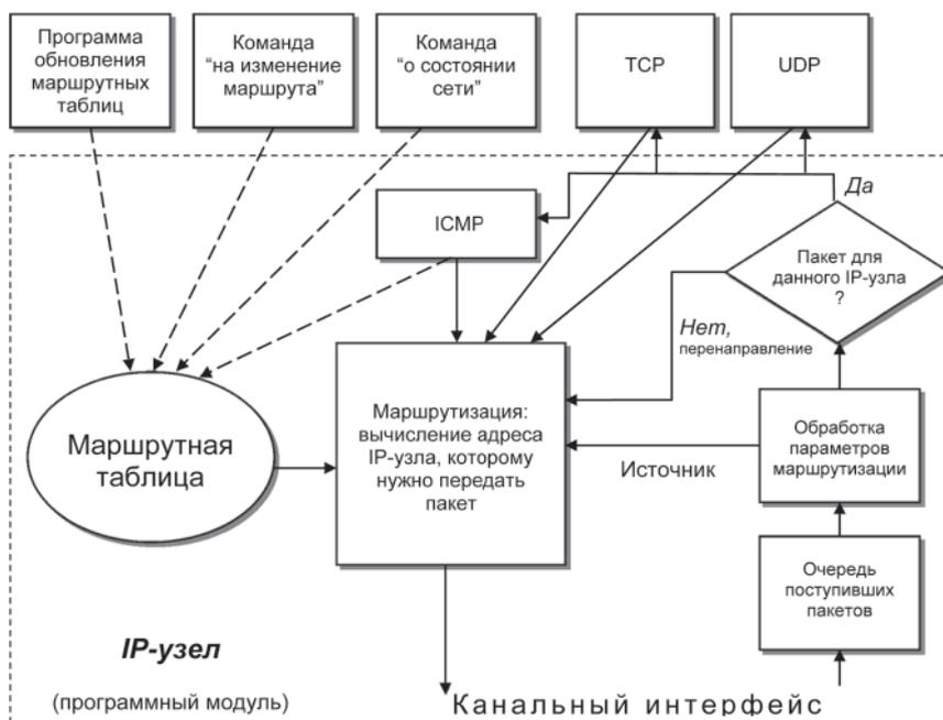
Рис. 1. Блок-схема алгоритма маршрутизации пакетов в IP-узле.
